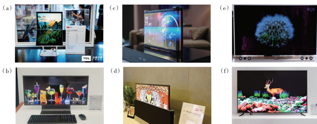
图 8 各家面板公司推出的喷墨印刷 OLED 原型显示器件。(a)TCL 华星 17 英寸印刷 OLED 折叠显示屏;(b)TCL 华星 31 英寸 4K 印刷 OLED 显示屏;(c)TCL 华星 17 英寸印刷 OLED 卷轴显示屏;(d)聚华 31 英寸喷墨印刷可卷绕 OLED 样机;(e)京东方 55 英寸 4K 印刷 OLED 显示屏;(f)TCL 华星 65 英寸 8K 印刷 OLED 显示屏。
